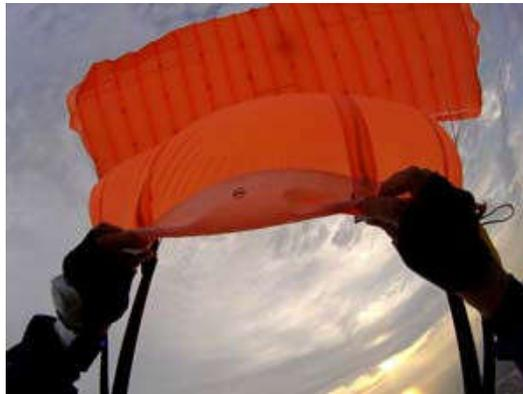
Lo slider termina ogni sua funzione con la completa apertura della vela. Se non vi siano necessità particolari di velocità, come per gli swoopers che hanno anche una versione staccabile, collassare lo slider ha il solo scopo di eliminare il fastidioso rumore del tessuto che sbatte al vento sopra la testa.
