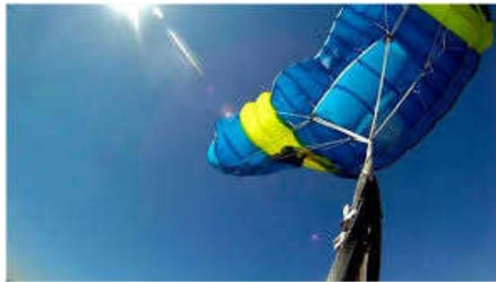
La ragione dell'avvitamento del fascio funicolare è una rotazione della d-bag (POD) durante l'apertura. Le cause sono generalmente quattro. Tre ovviabili con un ripiegamento più accurato, e una attinente ad una apertura in rotazione.
