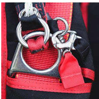
Il sistema RSL, Reserve Static Line, o Fune di Vincolo di Riserva, è un sistema ausiliario di apertura del paracadute di emergenza. Un moschettone dotato di sgancio rapido (in figura) è collegato ad una bretella del principale. In caso di sgancio, il principale, volando via, trascina una bretellina e/o un cavetto metallico, collegati con un semplice anello allo spinotto dell'ausiliario, sfilandolo.
