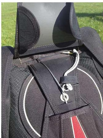
La RSL, o il suo equivalente Skyhook, NON SONO sistemi primari di apertura. Essi possono compensare eventuali ritardi o titubanze del paracadutista, ma non possono sostituire un'azione cosciente, completa e decisiva sullo spinotto da parte del paracadutista.
